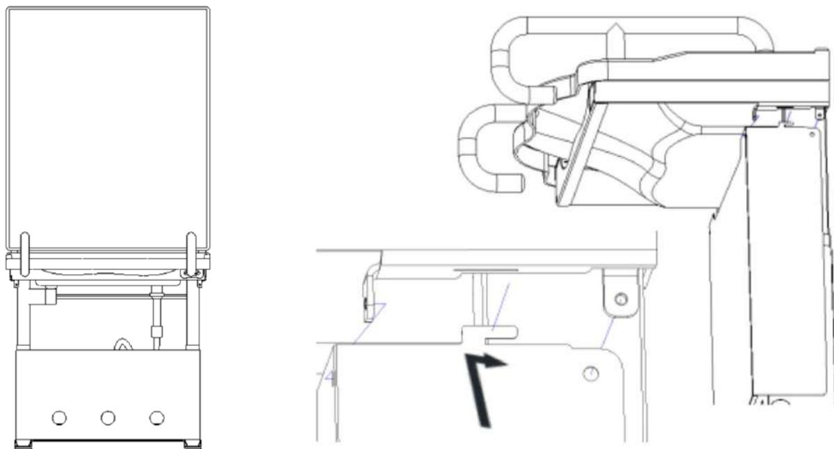
Précautions : Dans le cas d'une installation murale, le robinet de sortie sur le mur doit se situer dans les deux plages suivantes avant l'installation : plage d'installation de la vanne de sortie d'eau 1 : la hauteur du bord de la vanne de sortie d'eau par rapport au sol est comprise entre 70mm~280mm, et les largeurs gauche et droite sont de 450mm.
