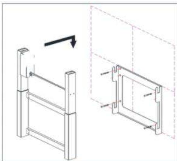
3. Placez la plaque de protection inférieure sur le module de la colonne. Notez que le crochet de la plaque de protection inférieure doit être accroché à la poutre de la colonne.
