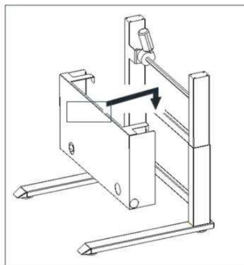
4. Verrouiller le support latéral précédemment installé sur les surfaces supérieures des poteaux gauche et droit à l'aide des [A. Vis à tête plate M6\* 15 x 8].
