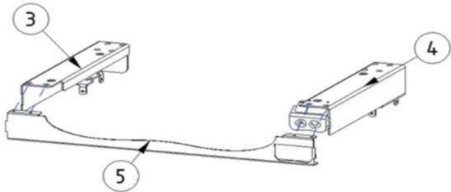
2. Bloquer l'ancrage X2 à l'extrémité inférieure des colonnes gauche et droite à l'aide des vis [B Vis M6\* 15 x 8].
