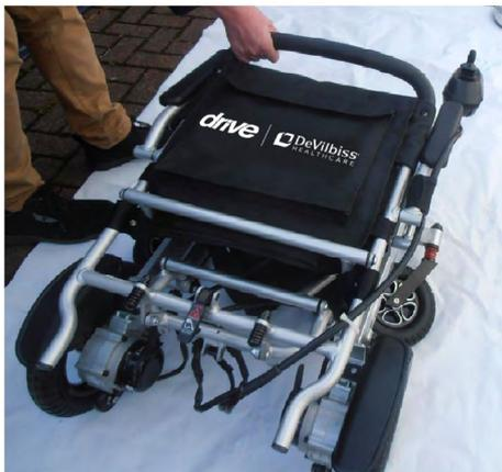
2. Vérifiez que le levier en dessous est verrouillé afin d'empêcher le fauteuil roulant électrique de se replier
