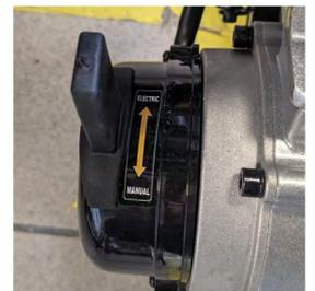
Assurez-vous que le fauteuil roulant électrique est à l'arrêt et qu'il est en mode « Electric » (électrique) avant de connecter le chargeur (voir image de droite)
