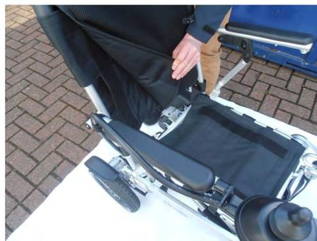
8. Insérez la batterie. Faites glisser la batterie sur les rails situés sous le siège. Poussez fermement la batterie vers l'arrière jusqu'à ce qu'elle se verrouille sur place en un clic audible.
