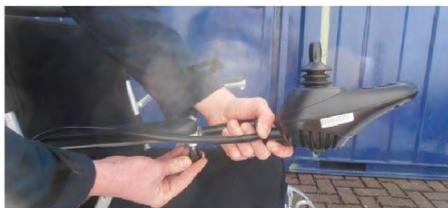
6. Vérifiez les deux connecteurs du joystick et de la batterie (cf cercle rouge ci-dessous) et connectez les deux connecteurs ensemble.
