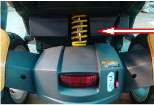
La fermeté de la suspension arrière est réglable. Il y a 5 niveaux de réglage. La capacité du système est d'environ 120 kg et chacun des niveaux peut porter jusqu'à 13,5 kg.
