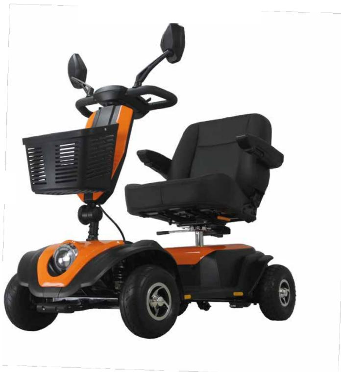
**Accoudoirs ajustables :** Inclinaison variable, et escamotable pour faciliter le transfert.
