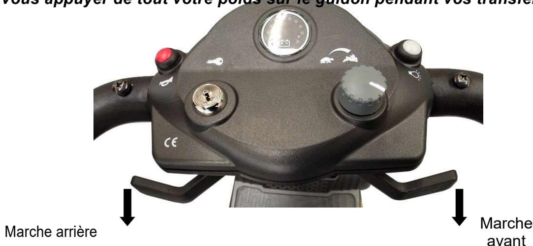
La vitesse et la direction (avant/arrière) du scooter se gère à l'aide du levier marche avant / marche arrière. Les flèches sur l'image ci-dessus vous indiquent la direction qui sera suivie par le scooter lorsque vous actionnez le levier dans un sens ou dans l'autre.
