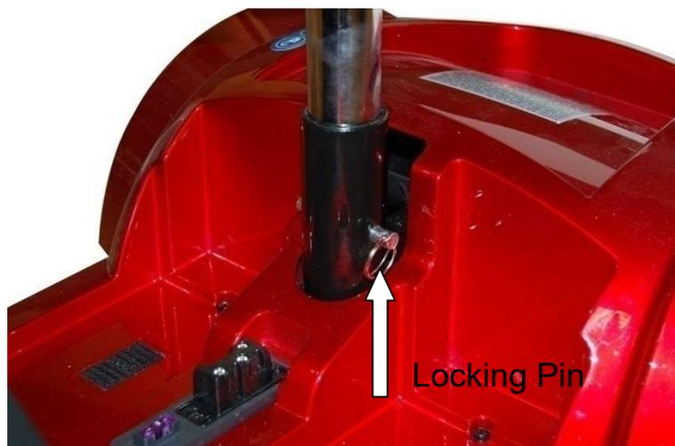
***En position la plus haute, la stabilité du scooter peut être modifiée car le centre de gravité est déplacé vers le haut.***
