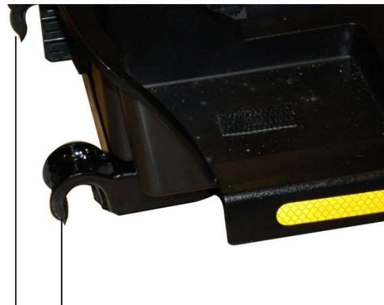
Crochets d'arrimage du châssis avant
