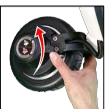
Schéma 52 Sécurisation de la roue libre
