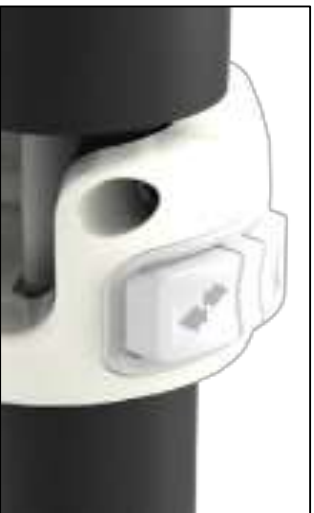
Schéma 27 Boutons de klaxon et de marche arrière
