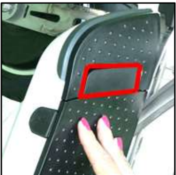
Schéma 56 – bouton de libération de la batterie
