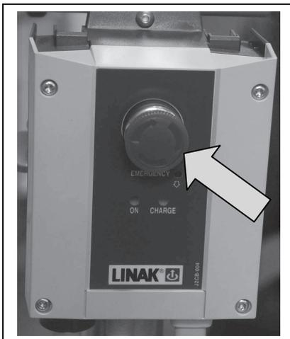
En cas d'urgence ainsi que lors du montage et du démontage, vous pouvez activer l'arrêt d'urgence en actionnant le bouton rouge du boîtier de commande.
