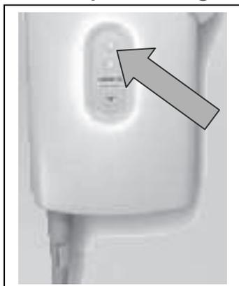
Lors de la charge des batteries, la diode supérieure est allumée avec un voyant jaune.
