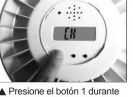
El Dispensador Automático de Pastillas dispone de una función incorporada para probar el dispositivo. Para entrar en el modo de prueba, presione el botón 1 durante 12 segundos, el símbolo "CH" deberá aparecer en la pantalla. Para salir del modo de prueba, presione el botón 3.
