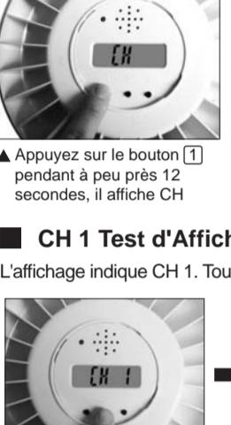
Le distributeur automatique de comprimés possède une fonction de test intégrée. Pour entrer dans le mode test, appuyez sur le bouton 1 pendant à peu près 12 secondes : le CH devrait apparaître sur l'affichage. Pour sortir du mode test, appuyez sur le bouton 3.
