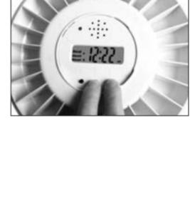
Il sistema di distribuzione automatica delle pilole ha come formato orario predefinito quello a 24 ore. Per cambiare in un formato a 12 ore, premi i tasti 2 e 3 simultaneamente. Sul lato destro del display apparirà il simbolo AM o PM, quando l'orologio è nel formato 12 ore. Rilascia i pulsanti quando viene mostrato il formato di orario desiderato.
