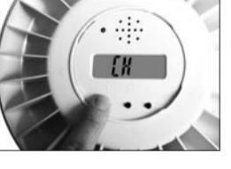
Der Automatische Tablettenspender hat eine eingebaute Funktion, um das Gerät zu testen. Um in den Testmodus zu gelangen, drücken Sie Taste 1 für ca. 12 Sekunden, bis das Symbol CH am Display erscheint. Um den Modus zu verlassen, drücken Sie die Taste 3.
