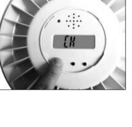
Il sistema di distribuzione automatico delle pillole ha una funzione interna per provare il dispositivo. Per entrare nella modalità Prova, premi il tasto 1 per circa 12 secondi, sul display apparirà il simbolo CH. Per uscire dalla modalità di prova, premi il tasto 3.
