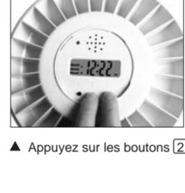
Le distributeur automatique de comprimés présente un format horaire de 24 heures, par défaut pour tous les boutons 2 et 3 simultanément. Les symboles AM ou PM apparaîtront sur le côté droit de l'affichage lorsque l'horloge sera paramétrée pour le format 12 heures. Relâchez les boutons lorsque le format horaire désiré est affiché.
