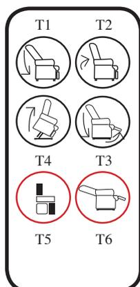
Certains fauteuils bi-moteurs sont équipés d'une télécommande à 6 boutons. Les 4 boutons supérieurs fonctionnent comme les boutons d'une télécommande 4 boutons d'un fauteuil 2 moteurs.
