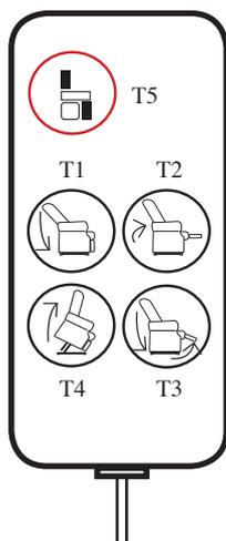
Cette télécommande est une variante de la télécommande 4 boutons. Les 4 boutons du bas s'utilisent et ont les mêmes fonctions que la télécommande 4 boutons d'un fauteuil releveur 2 moteurs
