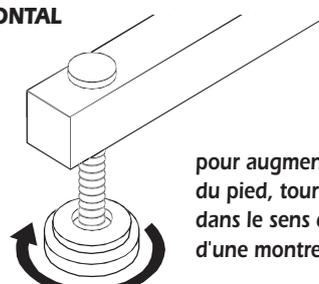
pour augmenter la hauteur du pied, tourner l'axe fileté dans le sens des aiguilles d'une montre
