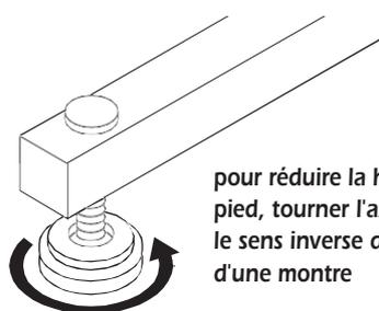
pour réduire la hauteur du pied, tourner l'axe fileté dans le sens inverse des aiguilles d'une montre
