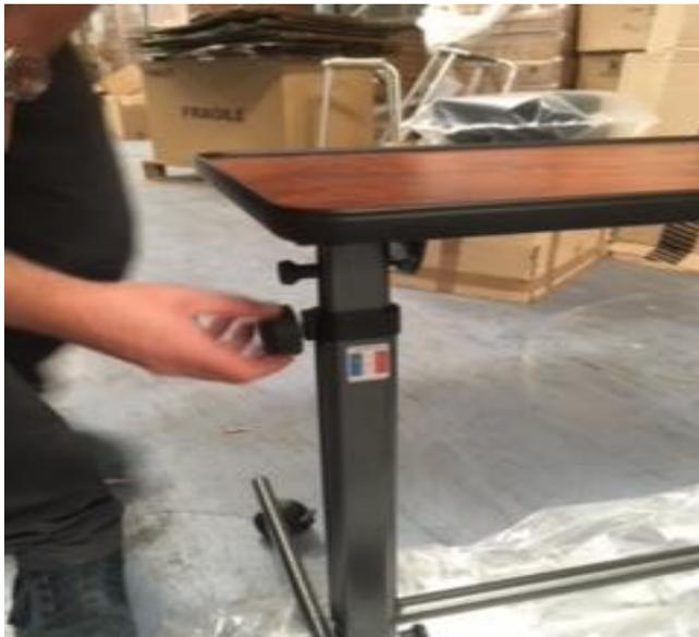
Etape 5 : Pour régler l'inclinaison du plateau tirer sur la manette de verrouillage tout en inclinant le plateau puis laisser revenir le doigt de blocage en position dans le trou correspondant à l'inclinaison choisie .
