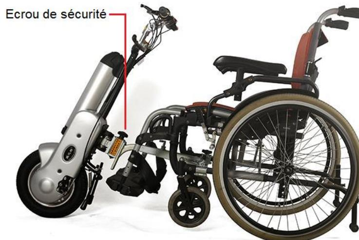
**MISE EN GARDE !** Veillez à bien serrer l'écrou de sécurité avant le fonctionnement. Veillez à bien attacher votre ceinture avant le fonctionnement. Ne faites pas de virages brusques lorsque la vitesse est élevée afin d'éviter tout risque de renversement
