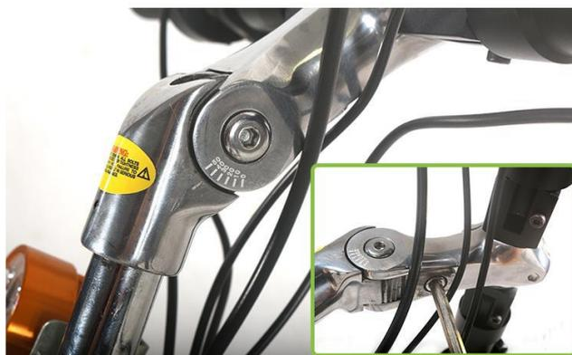
L'angle d'inclinaison du guidon peut être ajusté vers le haut ou vers le bas ; Voir le schéma ci-contre.
