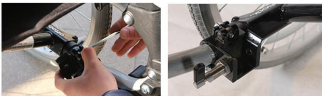
**Étape 2 :** Ajuster à la largeur du châssis du fauteuil
