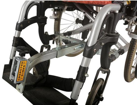
**Étape 4 :** Connecter avec la cinquième roue électrique et verrouiller l'écrou de sécurité pour la fixer
