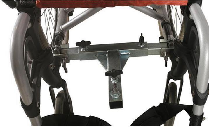
**Étape 3 :** Insérer l'élément de raccordement ajuster à la bonne profondeur puis le fixer
