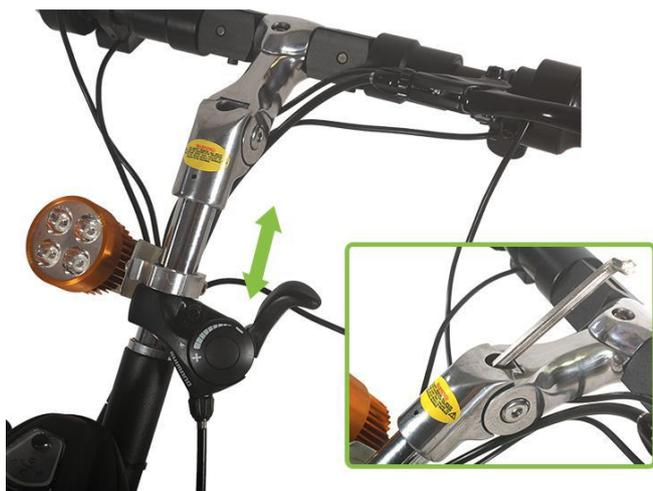
La hauteur du guidon de la Cinquième roue peut être ajuster en hauteur. Voir le schéma ci-contre.
