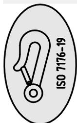
3. Les points de fixation du fauteuil roulant où doivent passer les sangles de fixation sont indiqués par le symbole ci-après.
