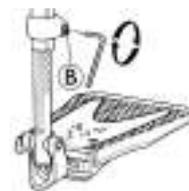
1. Desserrez la vis de fixation **B** à l'aide d'une clé Allen de 5 mm.
