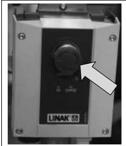
En cas d'urgence ainsi que lors du montage et du démontage, vous pouvez activer l'arrêt d'urgence en actionnant le bouton rouge du boîtier de commande. Enfoncez pour cela le bouton et faites-le tourner dans la direction des flèches. Si le bouton est entièrement enfoncé et tourné vers l'arrière, faites-le tourner dans la direction opposée aux flèches.
