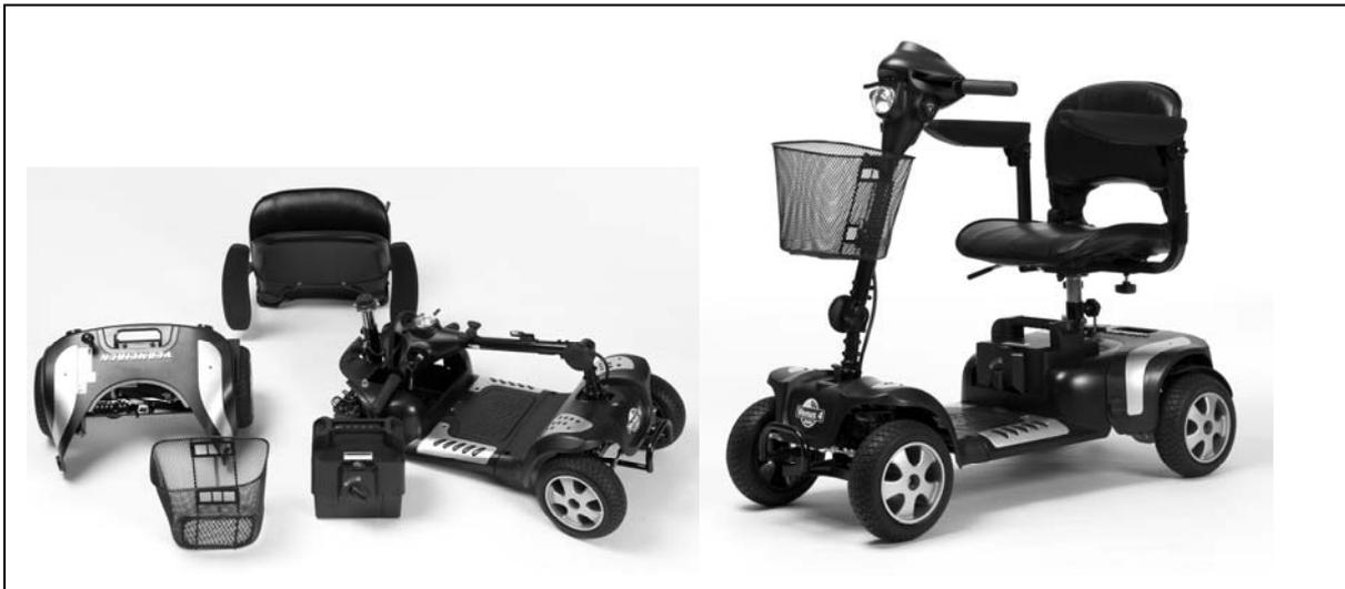
Le scooter peut être démonté en 4 parties, le siège (poids 5,6kg), le châssis avant (poids 19,90kg), le châssis arrière (12,85kg) et la batterie (poids 13,60kg) sans utiliser d'outils.
