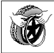
Placez le pneu intérieur sans air autour de la jante. Veillez à ce que la valve dépasse de l'ouverture de ventilation de la jante.
